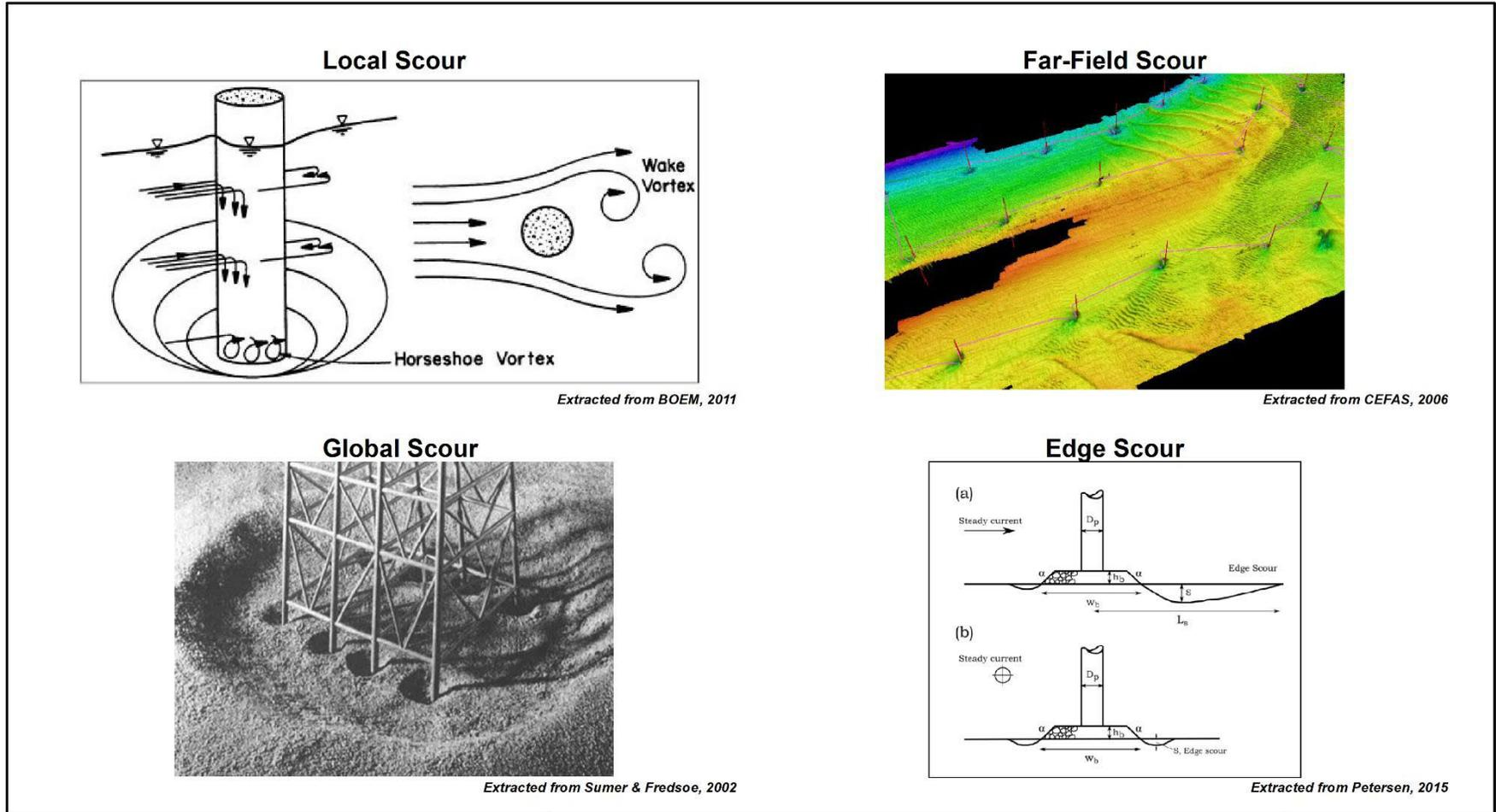
FIGURE EE.2-1: TYPES OF FOUNDATION SCOUR
