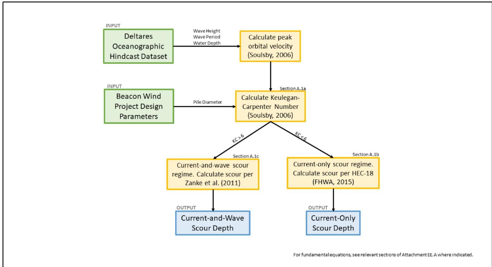
FIGURE EE.2-4: LOCAL SCOUR ESTIMATION FLOWCHART
