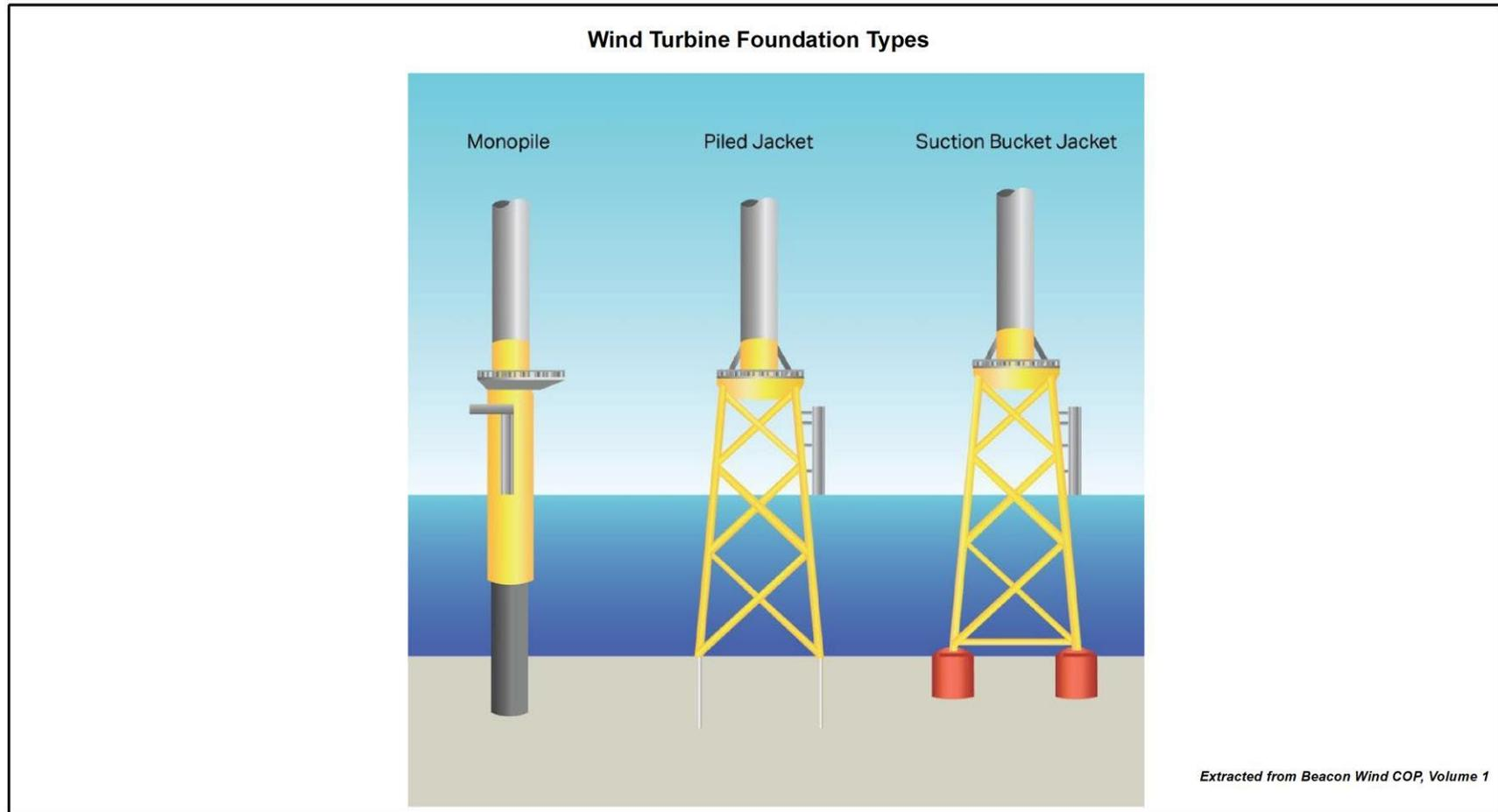
FIGURE EE.1-2: FOUNDATION TYPES
