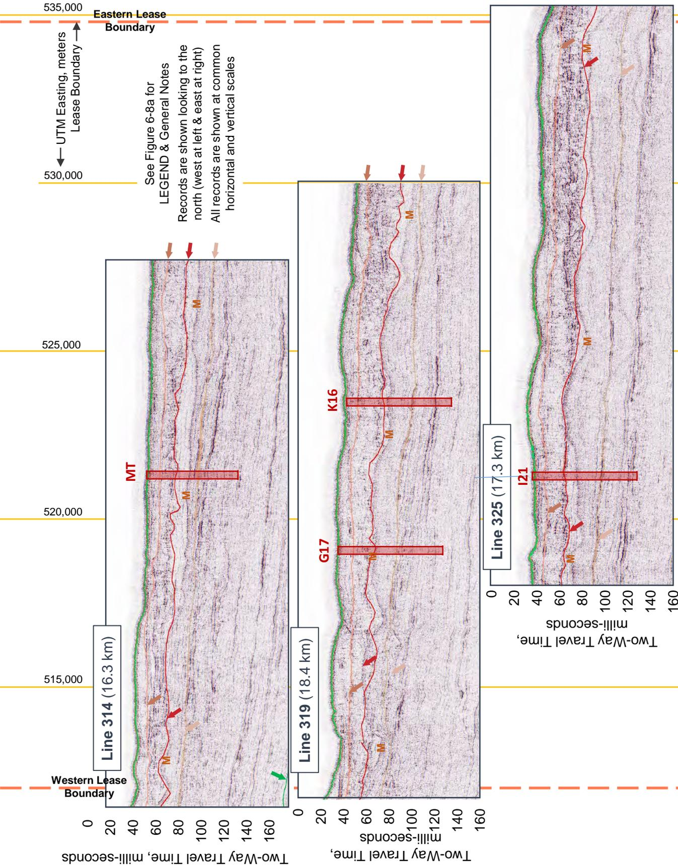
**EAST – WEST MID-PENETRATION, SEISMIC REFLECTION RECORDS**
