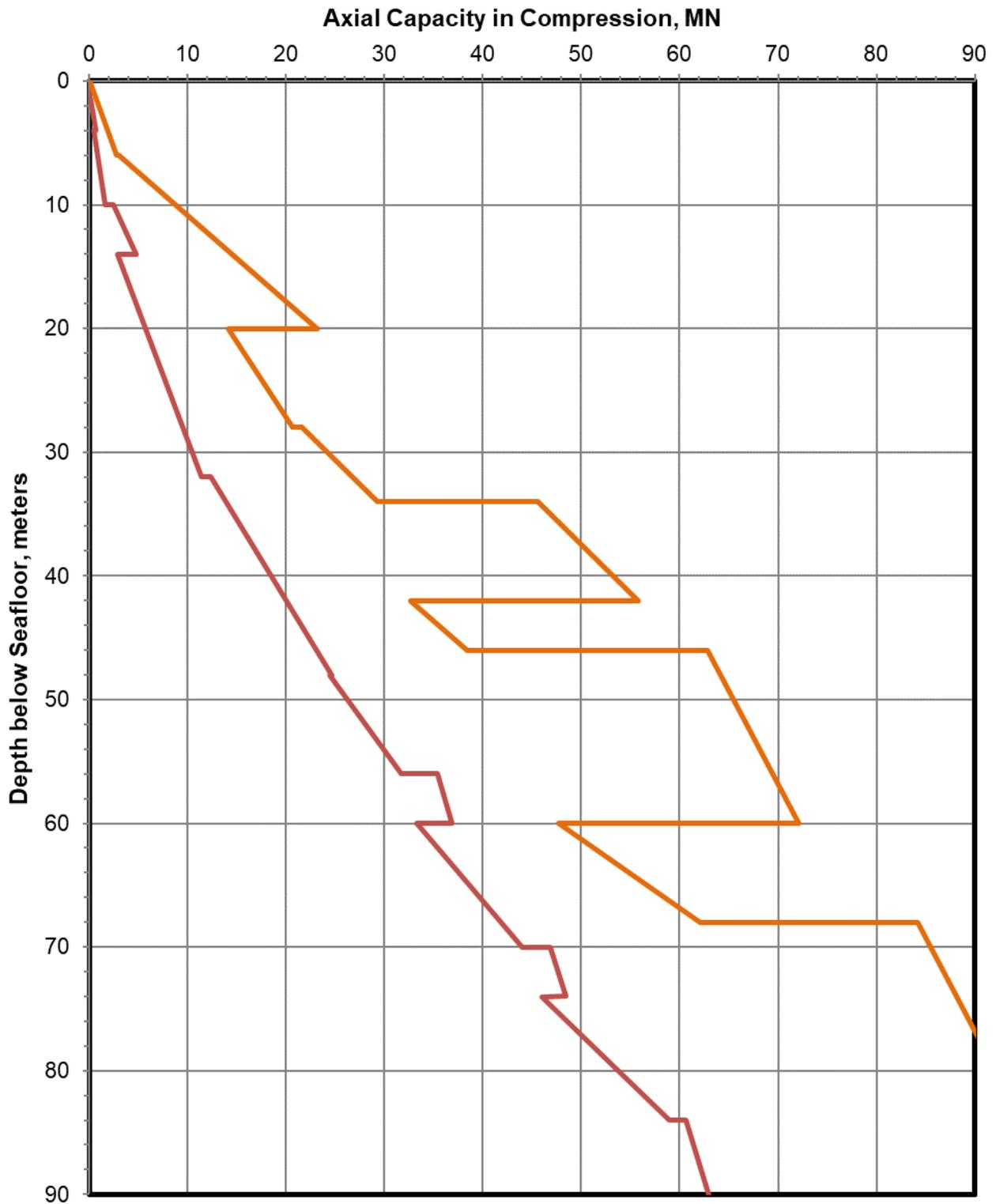
**COMPARISON OF GLOBAL LOWER- & UPPER-BOUND AXIAL PILE CAPACITY**
