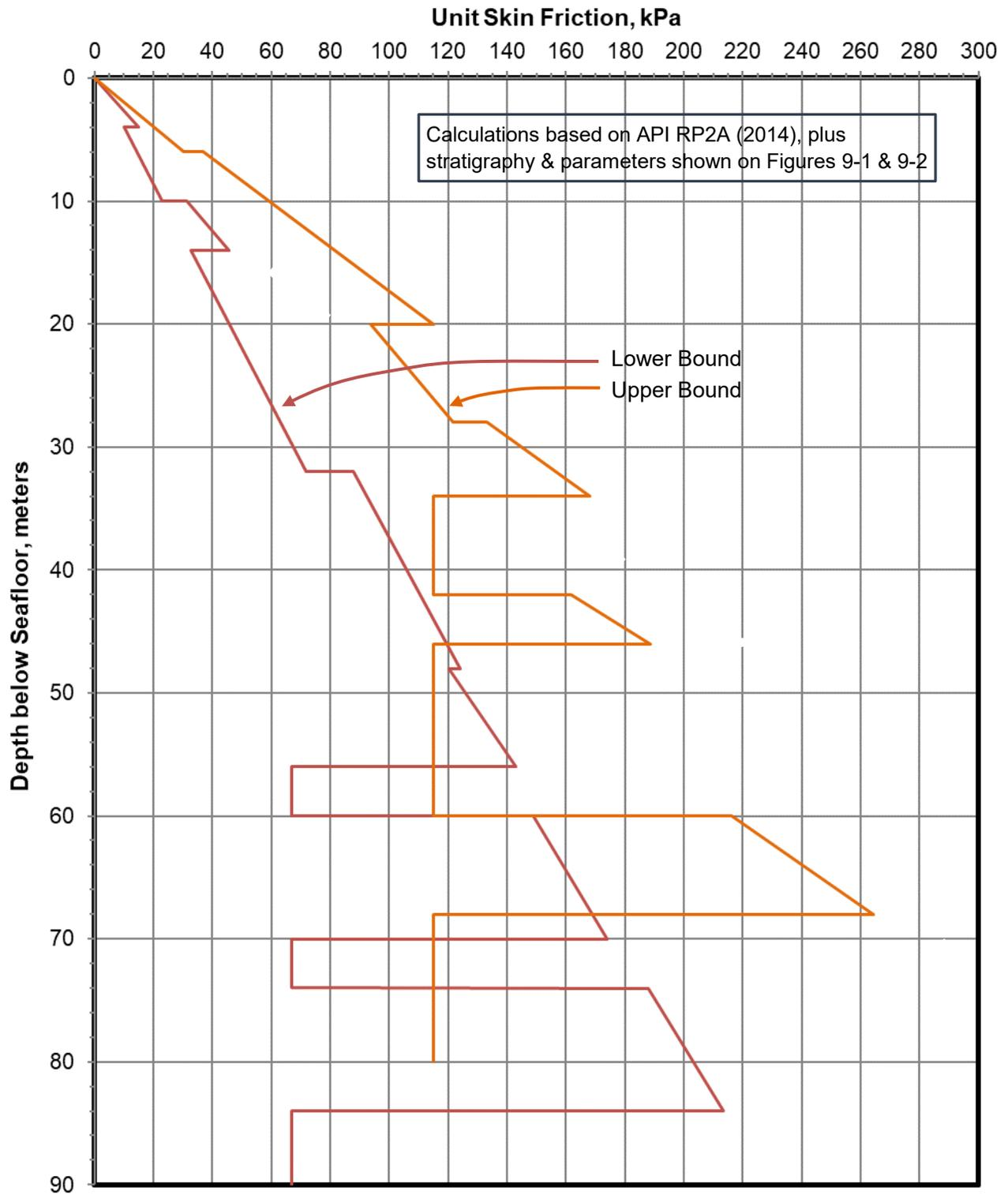
**ULTIMATE AXIAL PILE CAPACITY – UNIT SKIN FRICTION**
