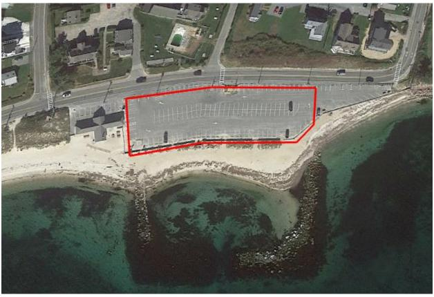
FIGURE 12-5. LANDFALL LOCATION OPTION 2 WITH REPRESENTATIVE HDD ENTRY POINTS: SURF DRIVE BEACH - SHORE STREET
